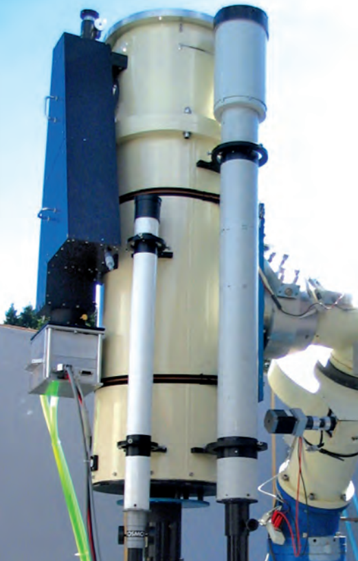
6 Der fertige Spektrograph mit angeschlossenem MegaTEK-CCD am Newton-Fokus. Der Okularauszug für den Guider ist am oberen Ende des Systems sichtbar.
