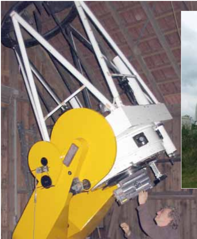
An diesem Teleskop mit 80 Zentimeter Öffnung kühlen vier Ventilatoren die Spiegelzelle (links). Für dieses Instrument wurde ein Gebäude mit Sechs-Meter-Kuppel errichtet, das hier in der Bauphase zu sehen ist (oben).
