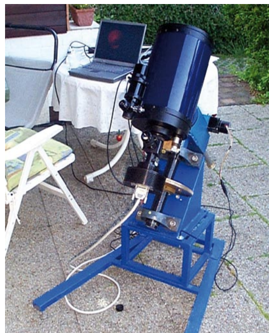
Abb. 1: Unsere Messungen des periodischen Fehlers eines Schneckengetriebes führten wir mit einem 8-Zoll-Schmidt-Cassegrain-Teleskop 2080B von Meade und einer ST-6-CCD-Kamera durch.
