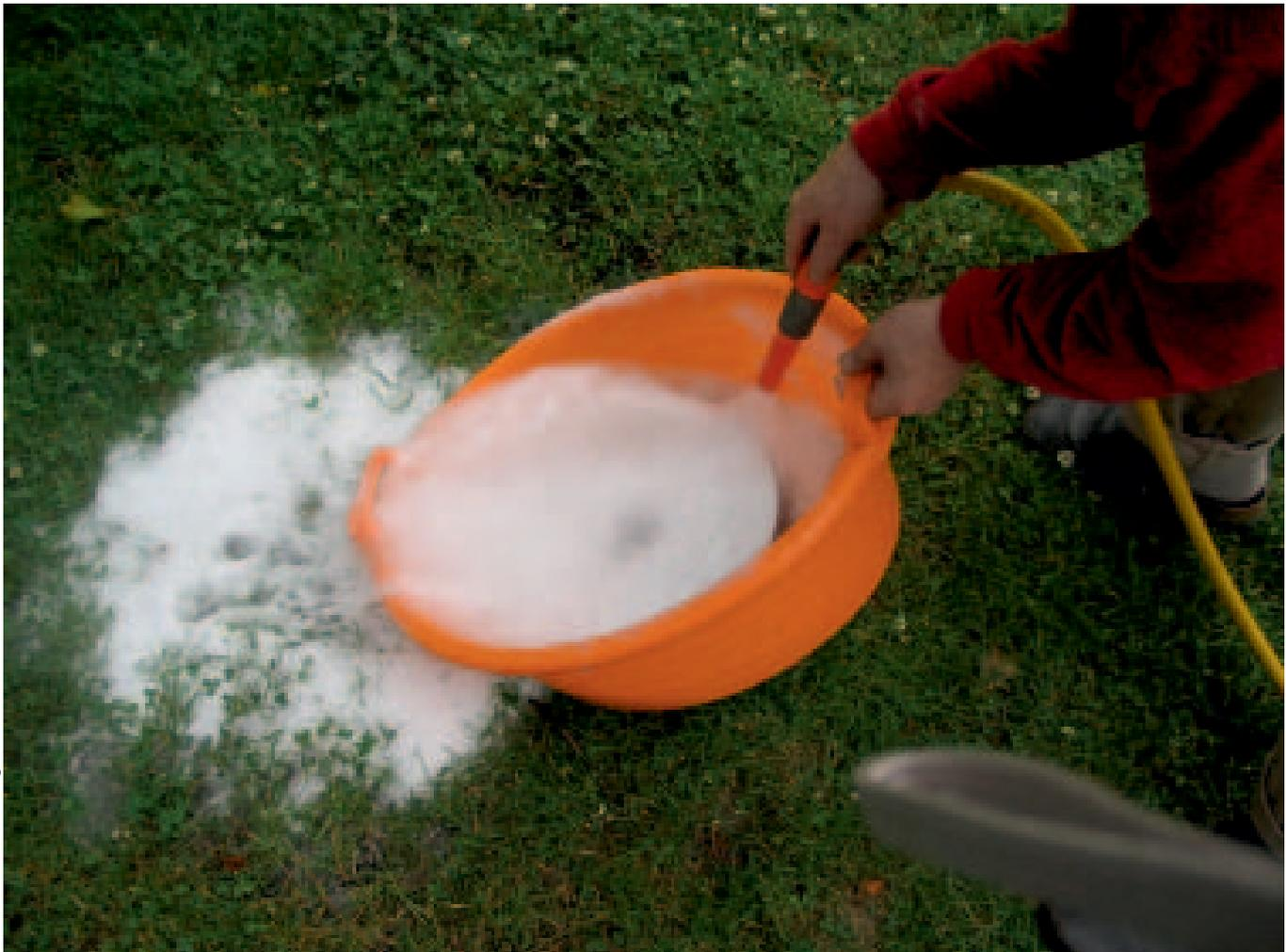
nügen völlig. Sie mögen nun vielleicht einwenden, dass bei einer Neuverspiegelung die alte Aluminiumschicht mittels Lauge abgetragen wird und dass Spülmittel ebenfalls eine Lauge ist. Allerdings ist die Seife des Spülmittels bei Weitem nicht so aggressiv und stellt daher kein Problem dar. Hat der Spiegel dann einige Stunden im Wasser gelegen, spülen Sie ihn mit
