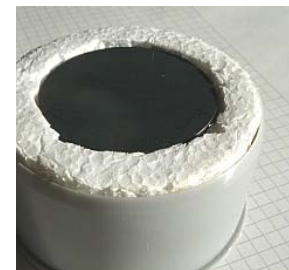
Der geschwärzte Alu-Zylinder in der Styroporummantelung.
