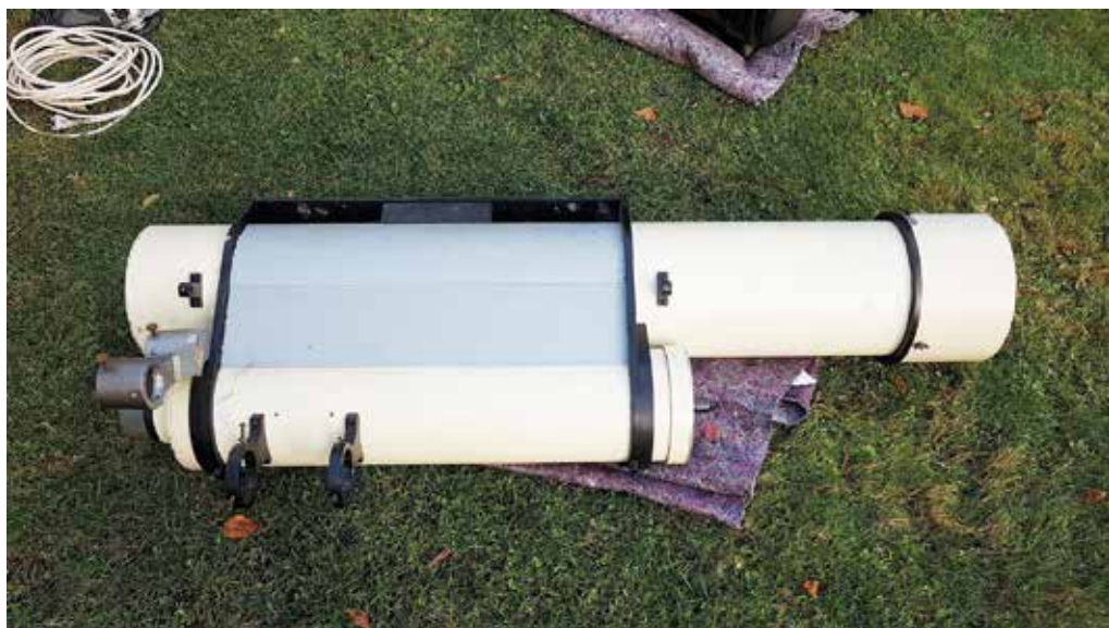
Ein 20-cm-f/10-Faltrefraktor nach Günter D. Roth
