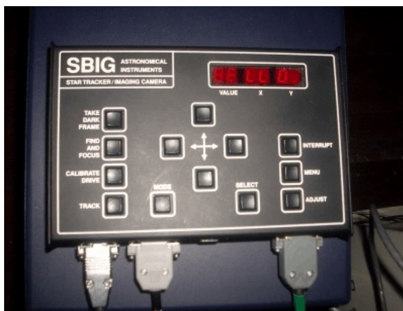
Abb. 6: Zum Nachführen verwendeter Autoguider
