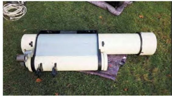
Ein 20-cm-f/10-Faltrefraktor nach Günter D. Roth
