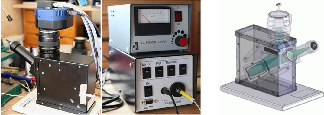
Abb. 14 & 15: Ansicht des eShel und seiner Kalibrationseinheit sowie die transparente Ansicht des geöffneten Seriengeräts (Shelyak Instruments).
