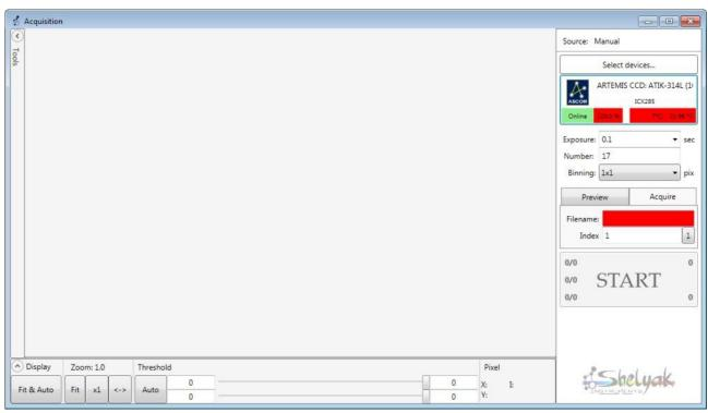
Die Kühlleistung und die Temperatur bleiben rot, bis die Zieltemperatur der Kamera erreicht ist. Nach ein paar Minuten: alles wird grün.
