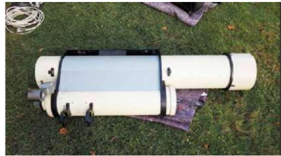
Ein 20-cm-f/10-Faltrefraktor nach Günter D. Roth
